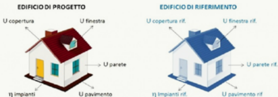
Figura 4 - Edificio di progetto ed edificio di riferimento
